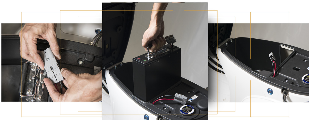
Batería de litio extraíble.
